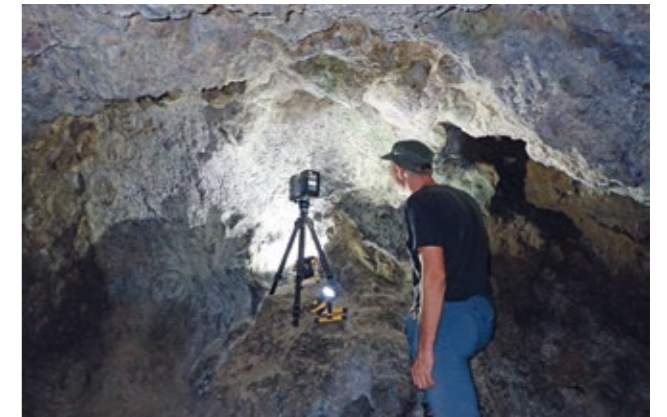
Abb. 2 Vaduz, Sennaloch. Die Vermessung der Höhle erfolgte mittels Laserscanner.
