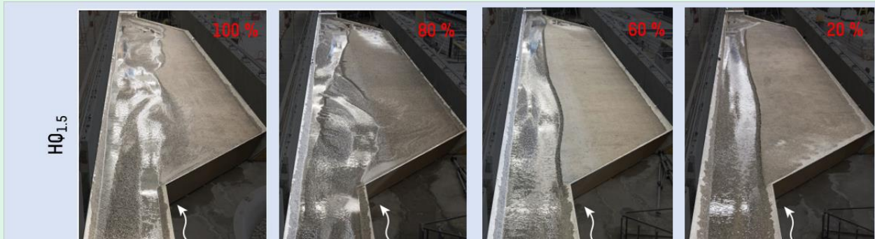
Abbildung 30: Flussaufweitungen für verschiedene Geschiebeverfügbarkeiten (Prozentualer Anteil der Geschiebetransportkapazität) [9].
