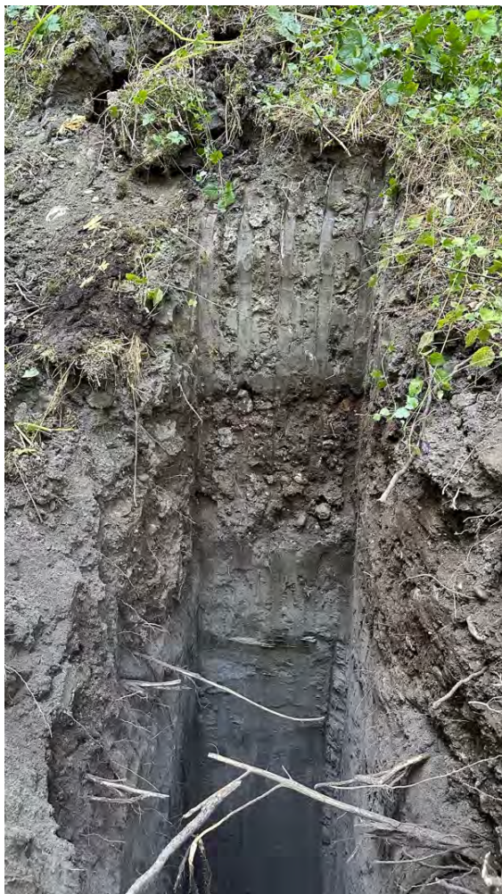
Deponieschüttung mit wenig Fremdkomponenten
