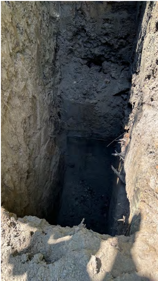
kaum Fremdkomponenten in Deponiematerial
