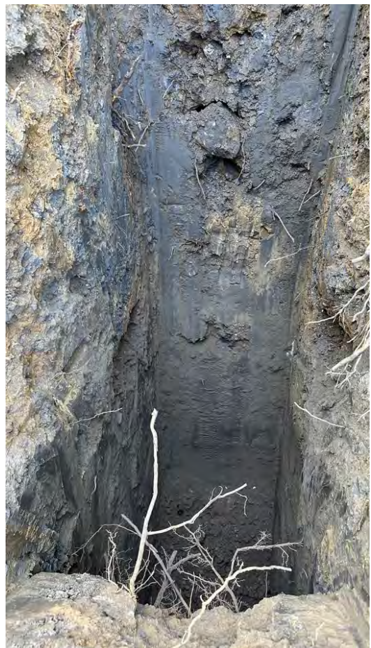
Deponiematerial über Überschwemmungsablagerungen
