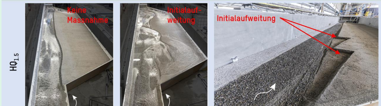
Abbildung 31: Flussaufweitungen mit Initialaufweitungen bei 60 % Geschiebeverfügbarkeit [9].
