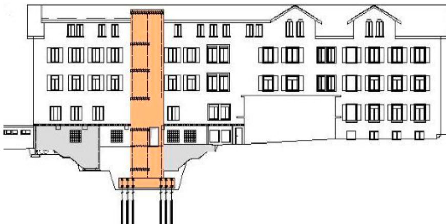
Ansicht an die hintere Längsfassade mit dem neuen Stahlbetonliftkern in der Mitte des Anbaus (Etape 1).
