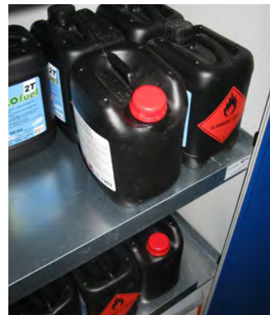
Brennbare Flüssigkeiten müssen in einem nicht brennbaren Schrank mit Auffangwanne gelagert werden,...
