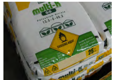
Brandfördernde Stoffe dürfen nicht mit entzündlichen oder brennbaren Stoffen im selben Brandabschnitt gelagert werden.
