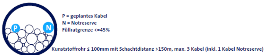
Abbildung 23 Kabelkanalisation: Frei verfügbare Kapazitäten bzw. Reserven - Kunststoffrohre
