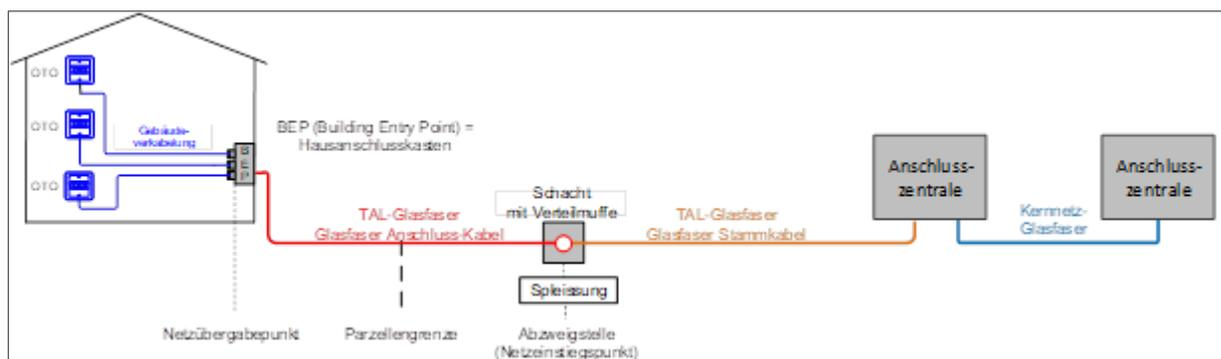
Abbildung 5: Teilnehmeranschluss mit den Elementen und Abschnitten OTO (optische Anschlussdose in Nutzungseinheit), Gebäudeverkabelung, BEP (Hausanschlusskasten), TAL-Glasfaser und Anschlusszentrale. Kernnetz-Glasfasern verbinden Anschlusszentralen. [Quelle: LKW]
