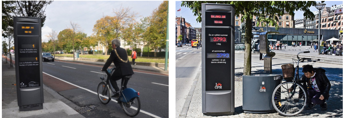
Abb. 8: Beispiele für automatische Zählgeräte mit Säulen
