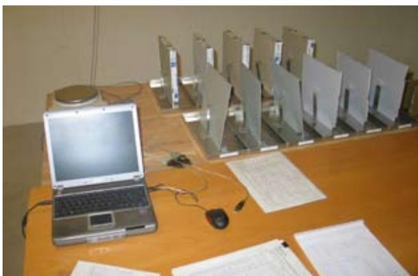
Untersuchung von feuchtespeichernden Materialien im Testraum bei relativen Luftfeuchten zwischen 40 % und 60 %
