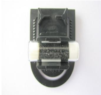
port der Schadstoffmoleküle durch Diffusionsvorgänge und nicht durch die Verwendung einer Pumpe. Der grosse Vorteil dieser passiven Methode liegt darin, dass keine externe Energieversorgung der Messstandorte notwendig ist und die Messeinrichtung nur wenig Platz benötigt (s. Abb. unten). Die Adsorption der Schadstoffmoleküle erfolgt auf Aktivkohle-Sorptionsröhrchen (s. Abb. links) des Typs ORSA (Fa. Dräger
