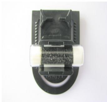
Transport der Schadstoffmoleküle durch Diffusionsvorgänge und nicht durch die Verwendung einer Pumpe. Der grosse Vorteil dieser passiven Methode liegt darin, dass keine externe Energieversorgung der Messstandorte notwendig ist und die Messeinrichtung nur wenig Platz benötigt (s. Abb. unten). Die Adsorption der Schadstoffmoleküle erfolgt auf Aktivkohle-Sorptionsröhrchen (s. Abb. links) des Typs ORSA (Fa. Dräger AG). Die Auswertung erfolgt
