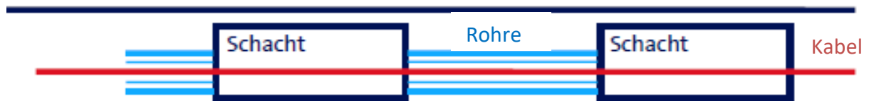
Abbildung 18 Realisierungsvariante: Verbindung Schacht – Schacht
