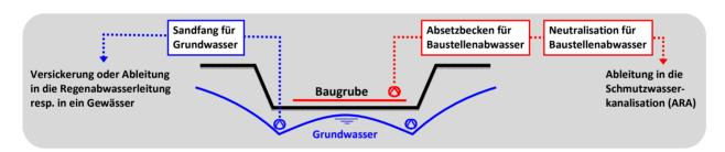
Offene Wasserhaltung (nasse Baugrube) Wird das Grundwasser durch eine offene Wasserhaltung aus dem Arbeitsbereich abgeführt, so besteht die Gefahr, dass das Wasser durch Grab- oder Betonierarbeiten trübe bzw. verschmutzt wird.
