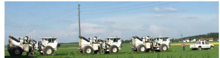
Vibratoren bei der Aussendung seismischer Wellen
