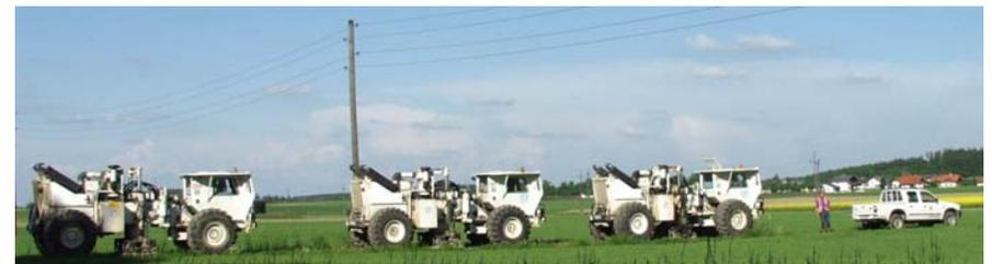
Vibratoren bei der Aussendung seismischer Wellen
