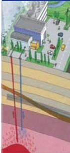
Geothermie nutzt die Wärme, die vom glühend heißen Erdkern ausgeht. Durch Bohrungen in großer Tiefe gelangen Thermalwasser oder -dampf an die Erdoberfläche. Mit dieser Wärmeenergie werden Generatoren betrieben, die Fernwärmenetze beschicken oder klimafreundlichen Strom erzeugen. Rund um die Uhr und unabhängig von Wind und Wetter.
