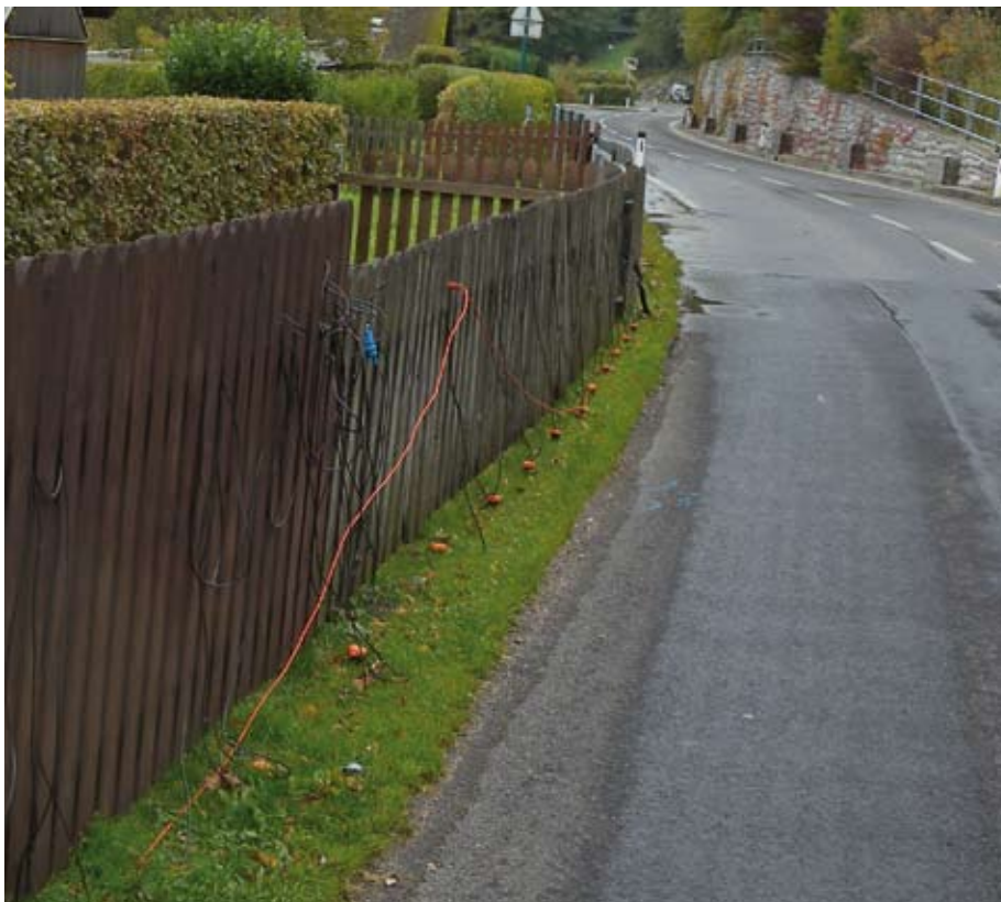
Die Geophone werden entlang der Messlinie ausgelegt. (Bild: Amt für Umweltschutz)
