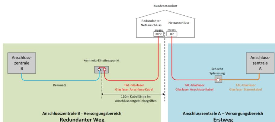
Abbildung 3 Redundanter Netzanschluss BEP-Z: Variante 1 – Kernnetz
