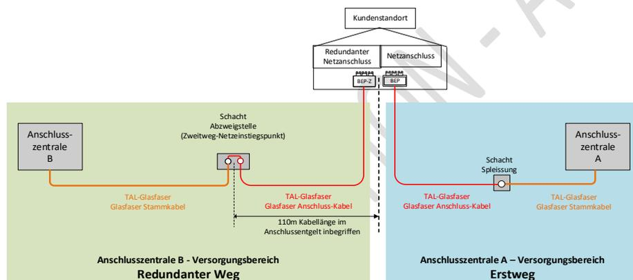
Abbildung 4 Redundanter Netzanschluss BEP-Z: Variante 2 – Angrenzende Anschlusszentrale
