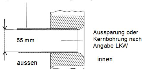
Abbildung 7 Einbau des Einführungsrohres
