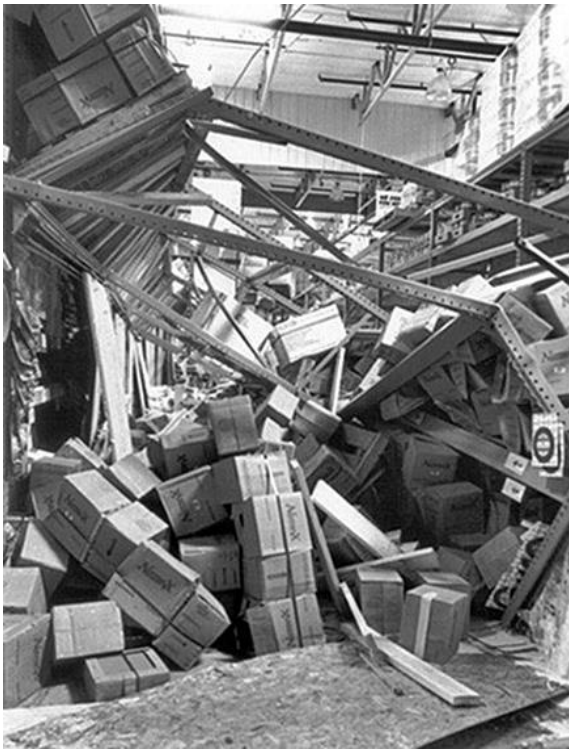
Abb. 2.23.1, 2.23.2 und 2.23.3 > Eingestürzte Hochregallager
