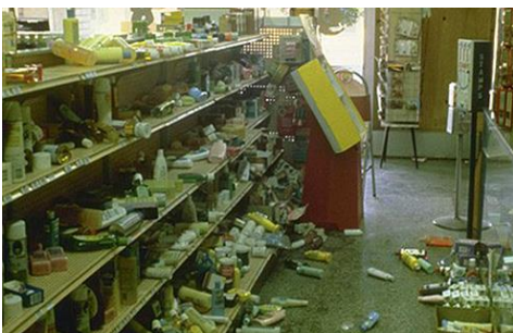
Abb. 2.22.7, 2.21.8 und 2.22.9 > Schäden trotz intakten Regalen
